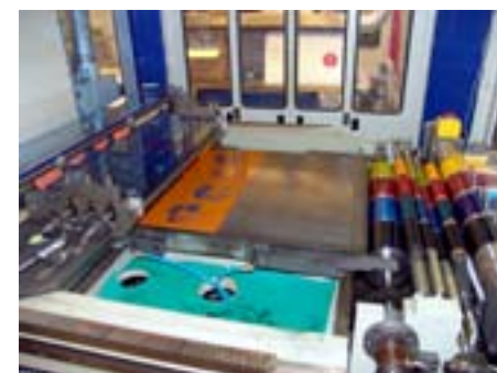
Offsettryck är ett snabbt sätt att trycka med fotokvalitet på cd-skivor. Tryckfärgerna kommer in från höger, läggs på tryckplåten (orange) varpå färgen valsas av och läggs på skivorna.
