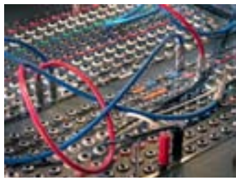
Sladdar, det är fint det. Här ett korskopplingsbord där man kopplar mixerns in- och utgångar till rätt signalkällor.
