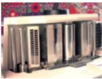
Vart jag såg, såg jag VU-meter vid VU-meter. 32-spårsbandspelaren är fortfarande kung i Ralphs studio. Visst kan man spela in och mixa allt digitalt, men Ralph anser att magnetbandet ger oöverträffad mjukhet i ljudet. Dessutom är den 7 kilo tunga, två tum breda bandrullen en utmärkt säkerhetskopiera.
