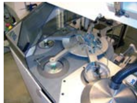
I efterbehandlingsmaskinen kommer skivorna in från höger, hamnar i sputterkammaren (längst ned), spin-coatas (mitten), UV-härdas (till vänster) och tas ut (längst upp).
