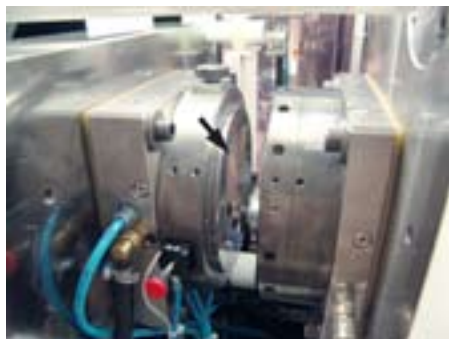
Matrisen (vid pilen) monteras i en platspruta, formen går ihop och plasten sprutas in.
