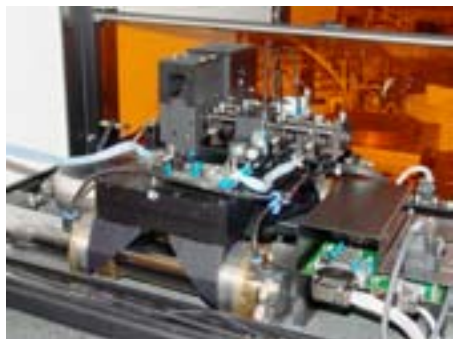
Matriseringsroboten innehåller hög-exakt laseroptik som glider fram på kraftiga gejdjar för att klara mikrometerprecisionen.
